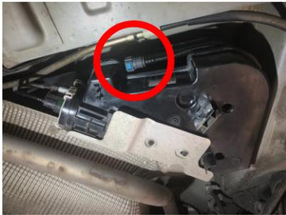
Démonter le carter de protection pour accéder au réservoir d'Eolys.
