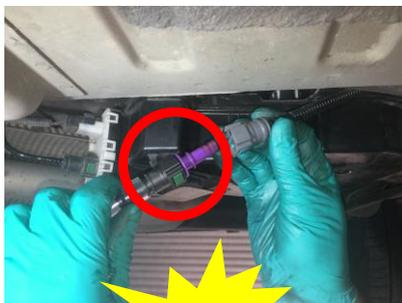
Clipser le tuyau de remplissage
