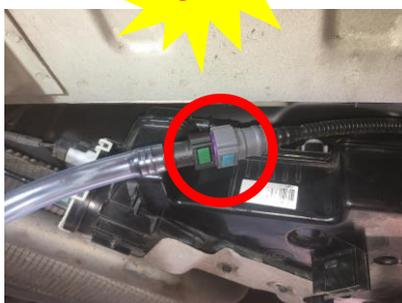
Vérifier le bon maintien au niveau du raccord
